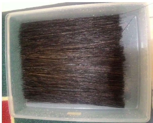
Gambar 2. Ijuk dipotong 295 mm dan direndam dalam larutan alkali
