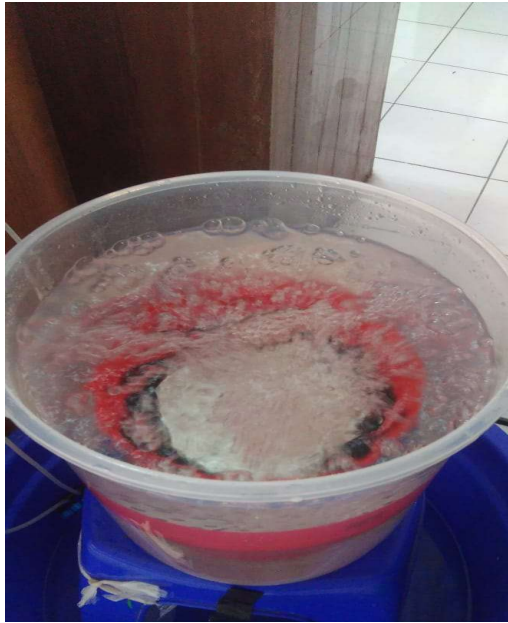
Gambar 3. Desain wadah aerasi dengan model reaktor mixed flow
