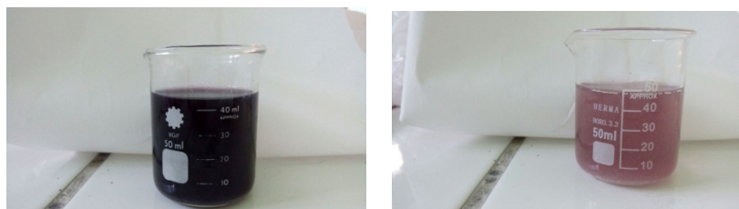
Gambar 3. Limbah sebelum dan setelah Proses Fotokatalitik skala laboratorium
