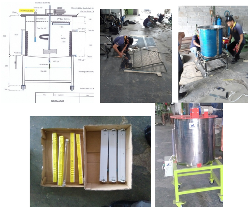
Gambar 2. Desain alat, proses pembuatan alat, lampu UV yang digunakan dan Alat setelah jadi
