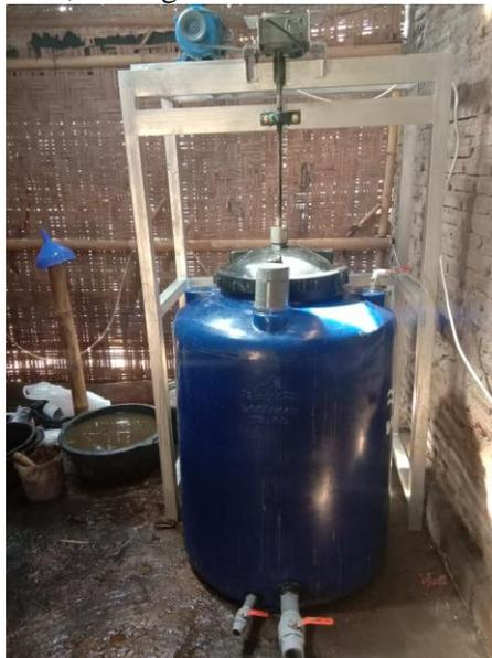
Gambar 1. Desain bioreactor biogas portabel
