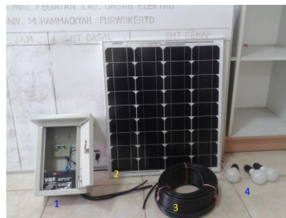
Gambar 2. Komponen penyusun sistem penerangan listrik tenaga surya.
