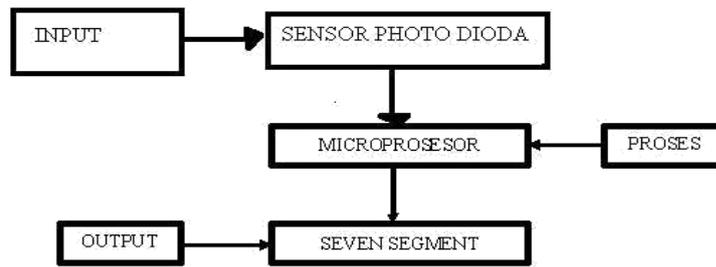
Gambar 2. Diagram Blok Visualisasi Sistem Kendali Lampu
