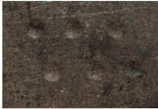
**Gambar 5.** Tapak indentor uji kekerasan Brinell
