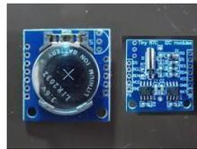
Gambar 10. Bentuk fisik Modul RTC DS1307
