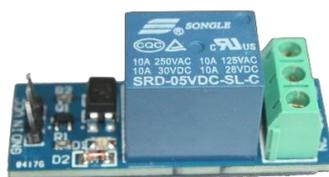
Gambar 9. Bentuk fisik relay
