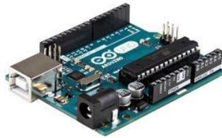
Gambar 6. Bentuk fisik Arduino UNO
