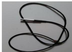
Gambar 8. Bentuk fisik sensor suhu atau *thermostat* tipe DS18B20
