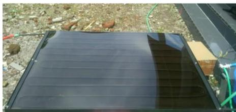
Gambar 5. Bentuk fisik kolektor pelat datar
