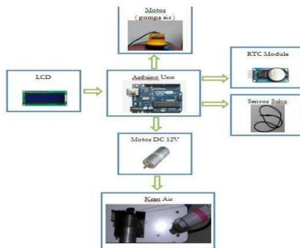
Gambar 3.3. Diagram blok sistem solar water heater pelat datar
