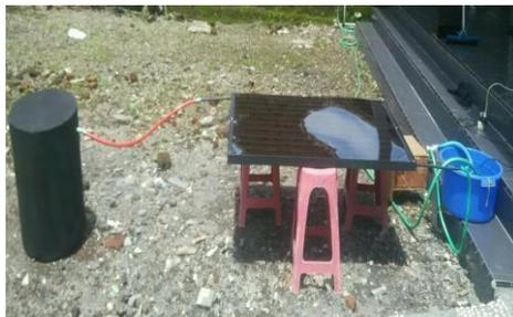
Gambar 4. Rancang Bangun *Solar Water Heater* dengan Pemrograman Arduino UNO
