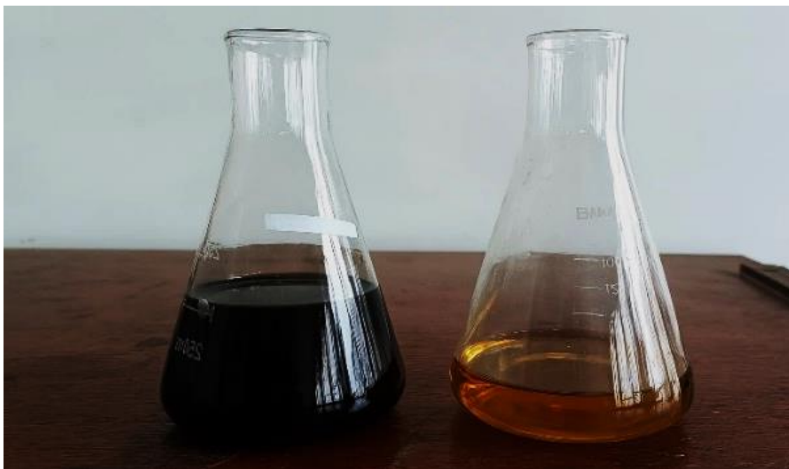
Gambar 1. Ekstrak Stevia Sebelum Dan Sesudah Proses Pemurnian Dengan Bentonit.
