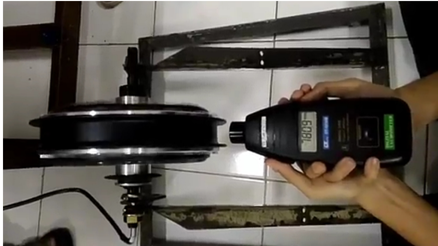
Gambar 8. Uji Kecepatan RPM Maksimal Tanpa Beban Pada Motor Penggerak
