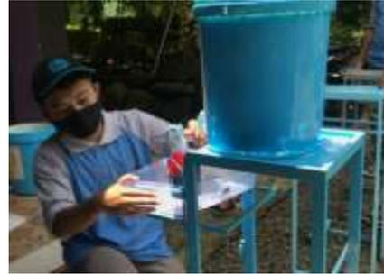
**Gambar 4.** Perakitan tempat cuci tangan sistem injak
