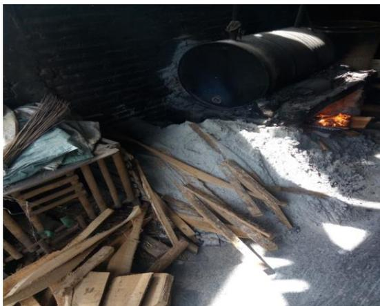
**Gambar 2.** Boiler Pabrik Tahu Purnomo
