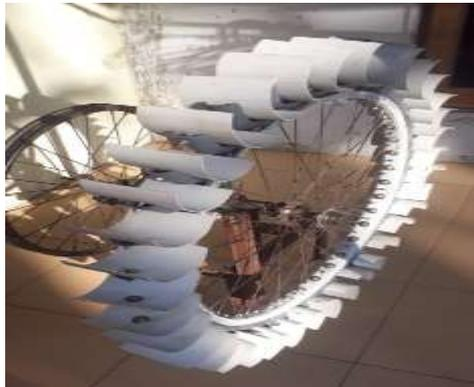
**Gambar 3.** Turbin air sistem mikrohidro
